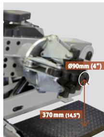
Ideale anche per molte ruote autocarro da 19" e 22,5".
