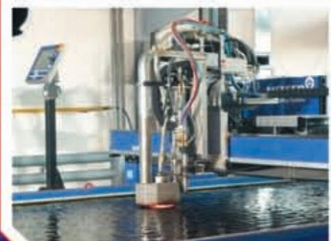
ЗАО «Сивер» оснащено современным оборудованием, обеспечивающим высокое качество выпускаемой продукции. В изготовлении элементов стапеля используется специальный металлокрепеж и передовые методы сварки, что обеспечивает надежную работу стапеля в самых тяжелых условиях.
