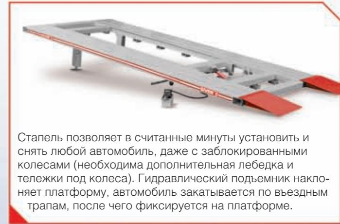
Стапель позволяет в считанные минуты установить и снять любой автомобиль, даже с заблокированными колесами (необходима дополнительная лебедка и тележки под колеса). Гидравлический подъемник наклоняет платформу, автомобиль закатывается по въездным трапам, после чего фиксируется на платформе.
