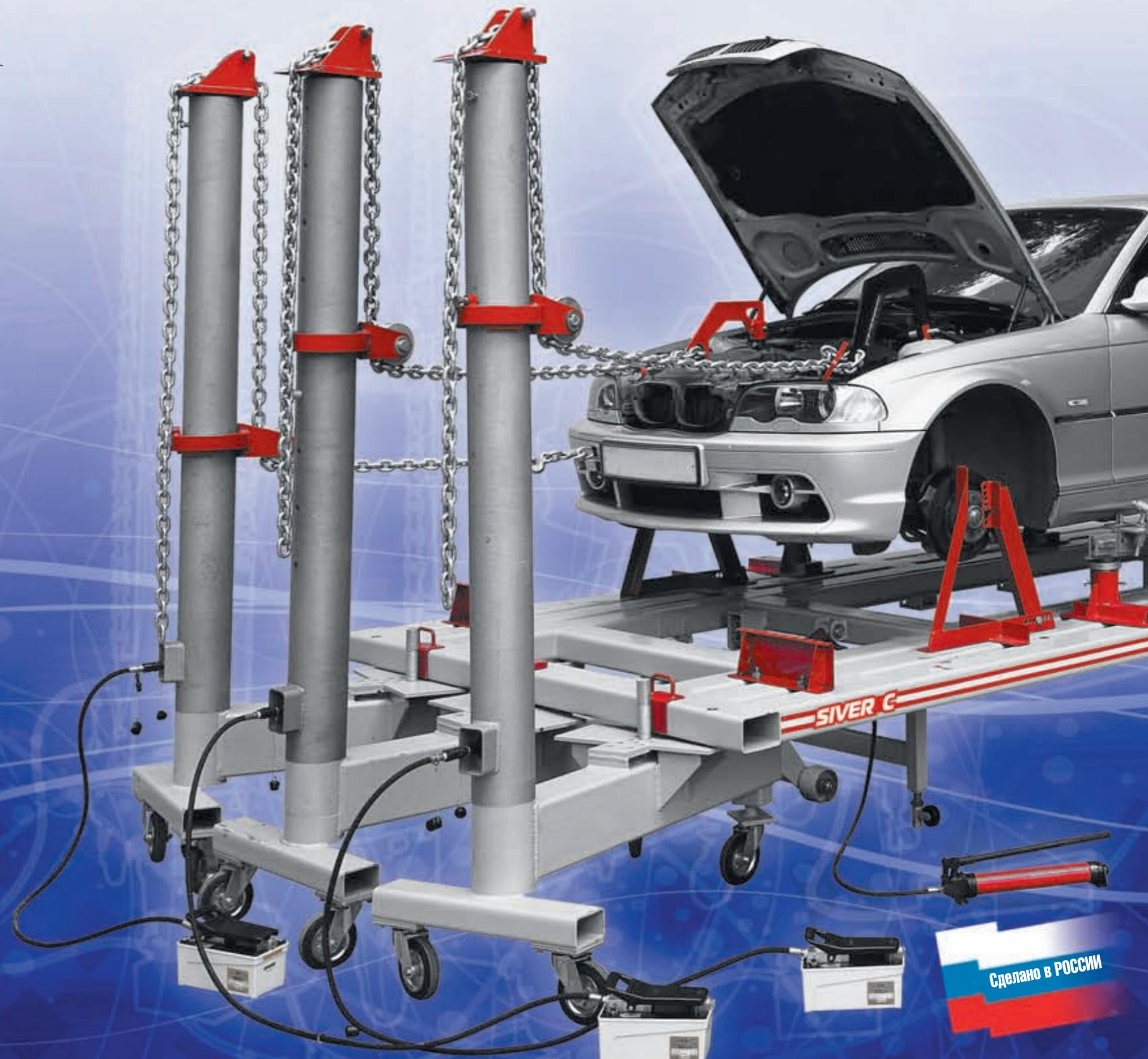
Рихтовочный стенд **SIVER C** предназначен для восстановления аварийных кузовов транспортных средств. Оборудование имеет сертификат соответствия требованиям безопасности (РОСС RU.MT20.B 08132) и пожизненную гарантию на платформу. Стапель имеет классическую американскую конструкцию с большой платформой и силовыми устройствами башенного типа.
